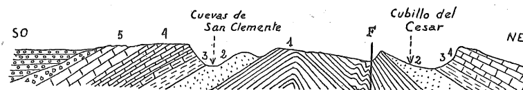
Fig. 1.—Corte transversal del anticlinal de Cuevas de San Clemente.
